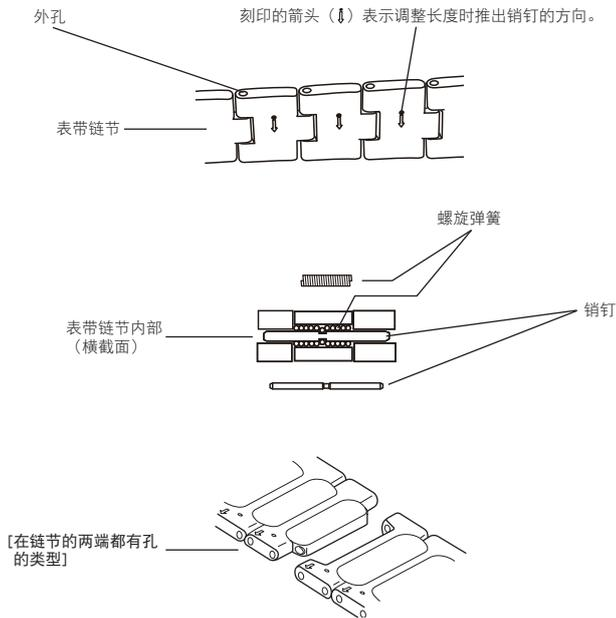
在链节的两端都有孔的表带上，调整距离箭头最近的销钉。不要拆下另一端的销钉。
