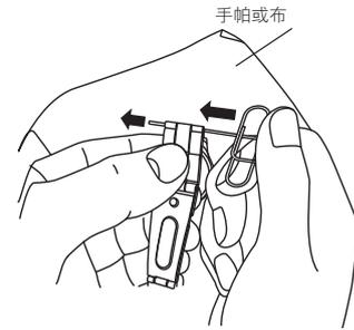
拆下多个链节时，请从带扣的两侧对称地拆下，以保持表带的平衡。拆下3个链节时，请从12时一侧拆下1个链节，而从6时一侧拆下2个。这样能使手表更容易佩戴。
